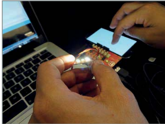
Bild 3. Die LED leuchtet bei Berührung des Bildschirms.
