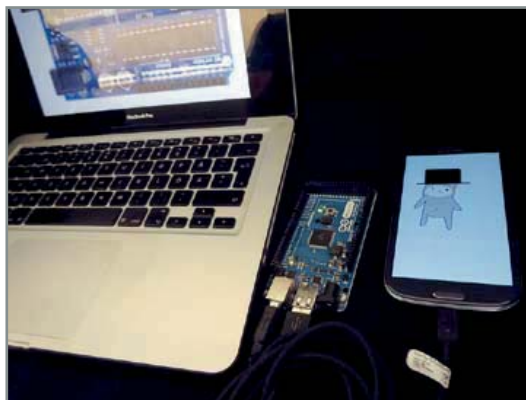
Bild 2. Arduino Mega ADK, angeschlossen an einen PC und ein Smartphone.
